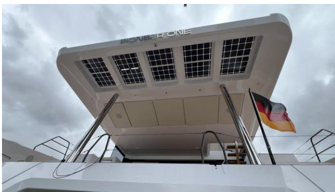
Solarpanel auf dem Dach der PIONEER ONE
